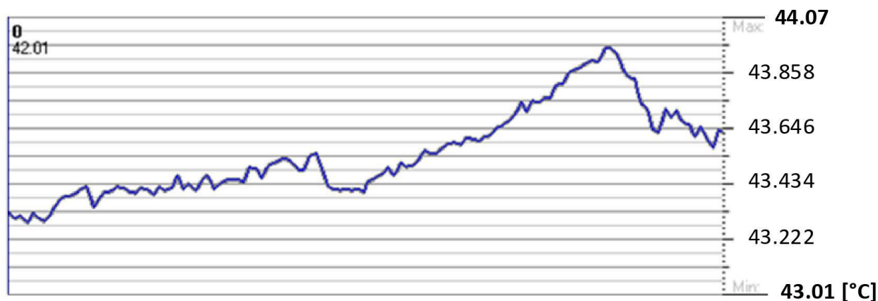
Рисунок 24 – График изменения температуры поверхности по контрольной линии I-I на термографическом снимке очищенной поверхности ВЗП
