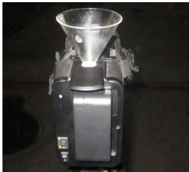
Рисунок 15 – Термограф IRTIS-2000, охлаждаемый жидким азотом
