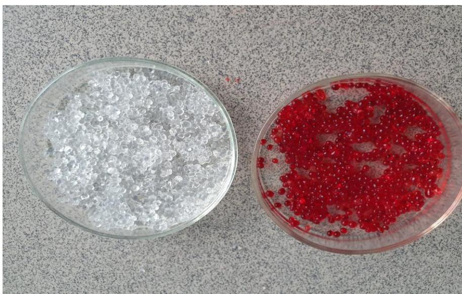
Рисунок 61 - Капсулы, полученные на экспериментальной установке
