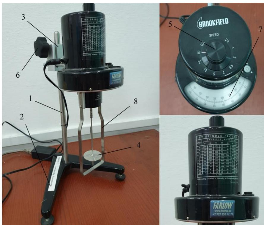
1 - штанга; 2 - станина; 3 - зажим; 4 - ротор; 5 - регулятор скорости; 6 - винт; 7 - круговая шкала; 8 - защитная рамка
