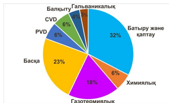
Сурет 2 – Жабынды жағудың түрлі әдістерін қолдану кеңдігі
