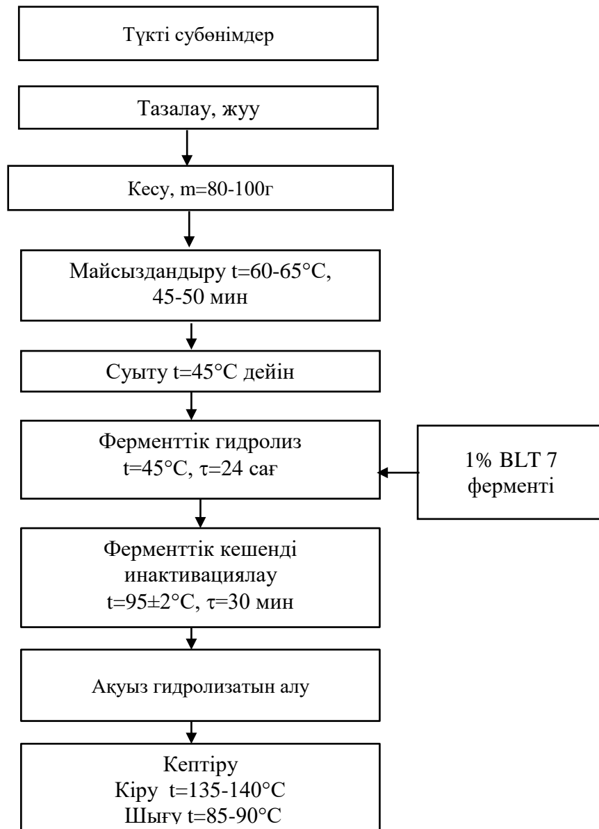
Сурет 13 – Түкті субөнімдерден ақуыз гидролизатын алудың технологиялық сұлбасы
