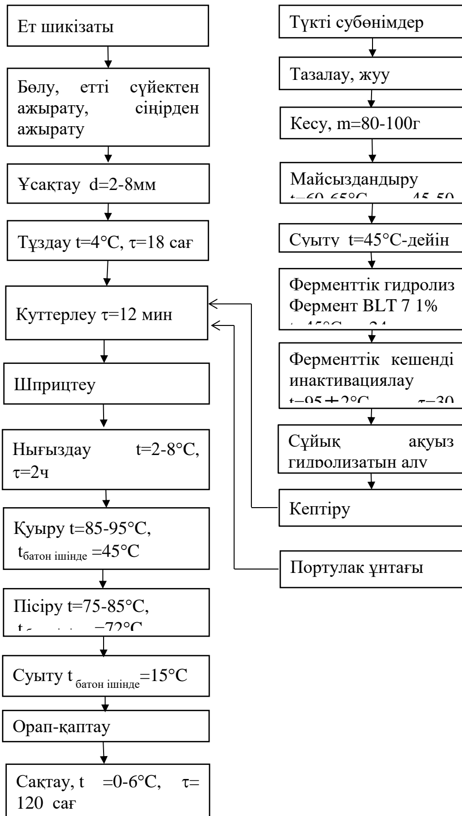
Сурет 21 – «Баянауыл» геродиетикалық шұжық өнімдерін өндірудің технологиялық сұлбасы
