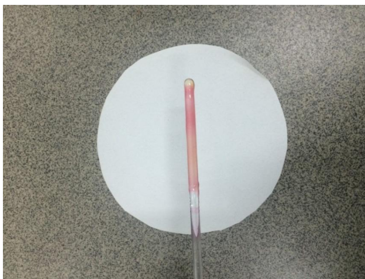
Рисунок 14 - Тест-система, полученная на основе 2% альгината натрия и \text{Ca}^{2+}
