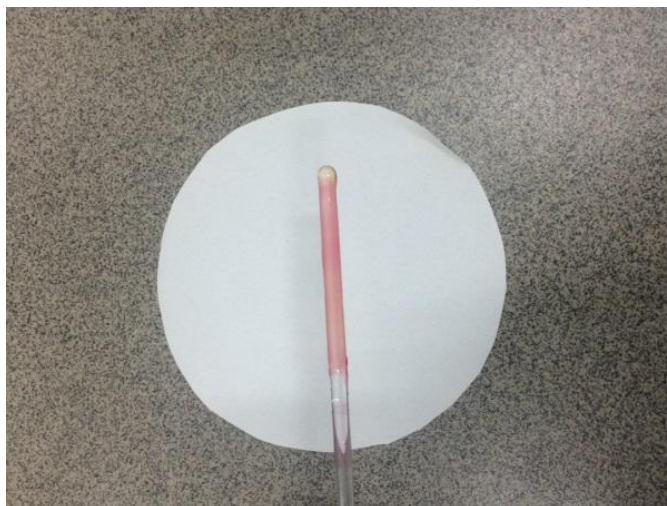
Рисунок 12 - Тест-система, полученная на основе 3% желатина и глутарового альдегида
