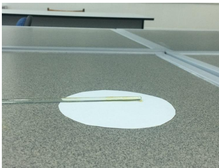
Рисунок 11 - Апробированная тест-система в молоке с карбофосом (>0,05 мг/кг) на основе альгината натрия (2 %)
