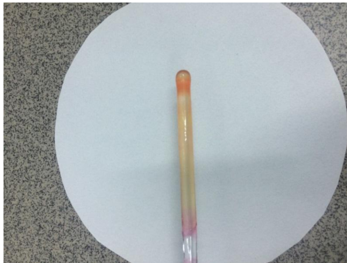
Рисунок 16 - Апробированная тест-система в молоке с карбофосом ( >0,05 мг/кг) на основе низкометилированного пектина (2%) и хлористого кальция (0,1 %)
