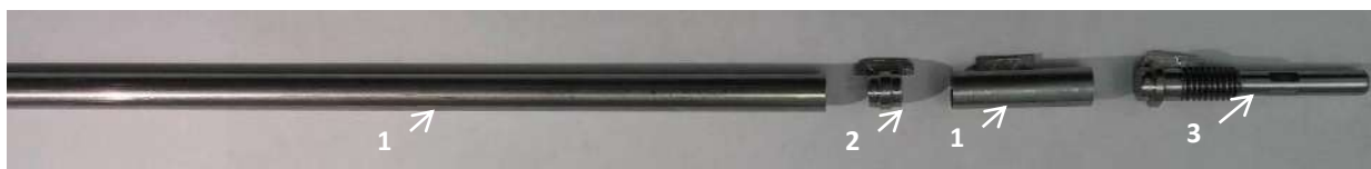
а) детали твэла: оболочка (1), кольцо опорное (2), заглушка концевая (3)
