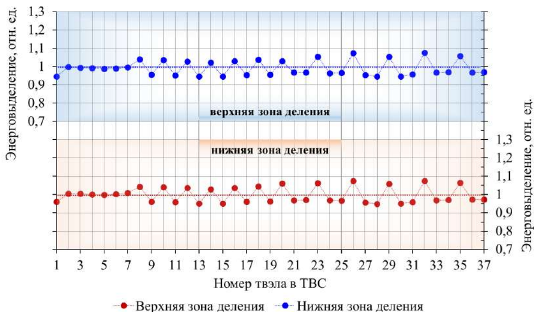
Рисунок 23 – Распределение мощности в нижней и верхней зонах деления по высоте твэлов с обогащением в рядах твэлов 17 %, 12,7 % и 8,94 % (в угловых твэлах периферийного ряда 8,25 %)
