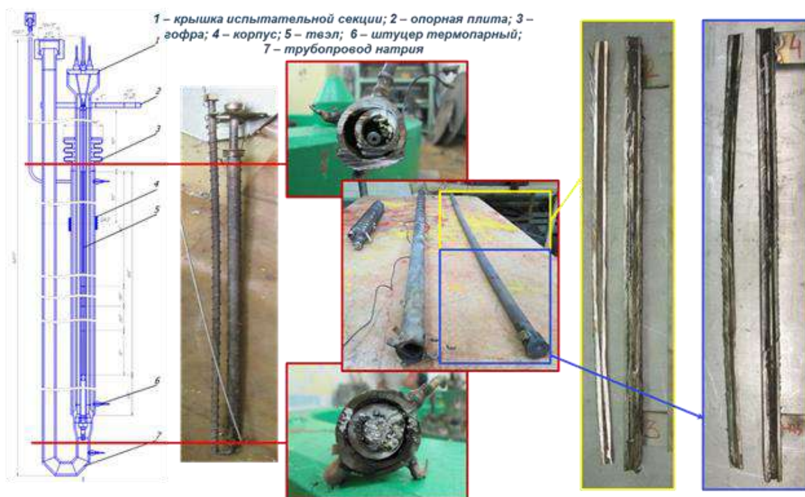
Рисунок 70 – Фрагменты испытательной секции экспериментального устройства
