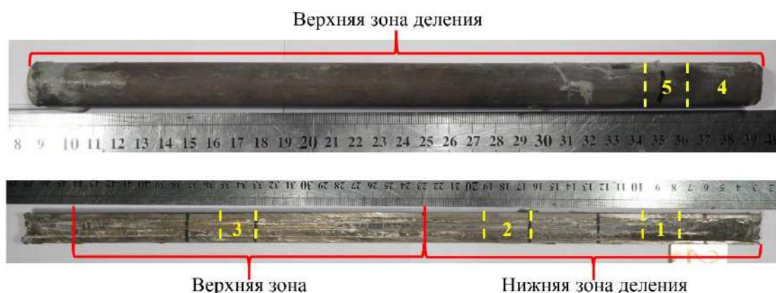
Рисунок 71 – Схема вырезки образцов из фрагментов ИС ЭУ ПК
