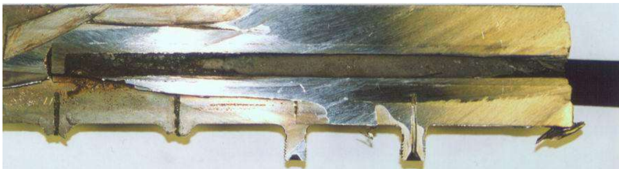
Рисунок 37 – Топливо после плавления внутри танталовой вставки после эксперимента GP-2
