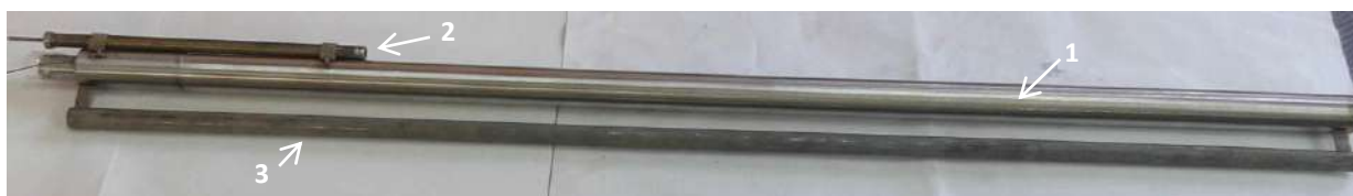
б) корпус (1) в сборе с узлом установки монитора (2) и имитатором трубы натрия (3)
