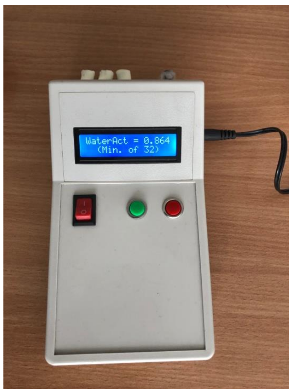
Рисунок 2 – Прибор для измерения активности воды
