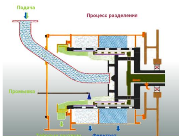
Рисунок 1.11 - Схема технологического процесса в центрифуге LLW
