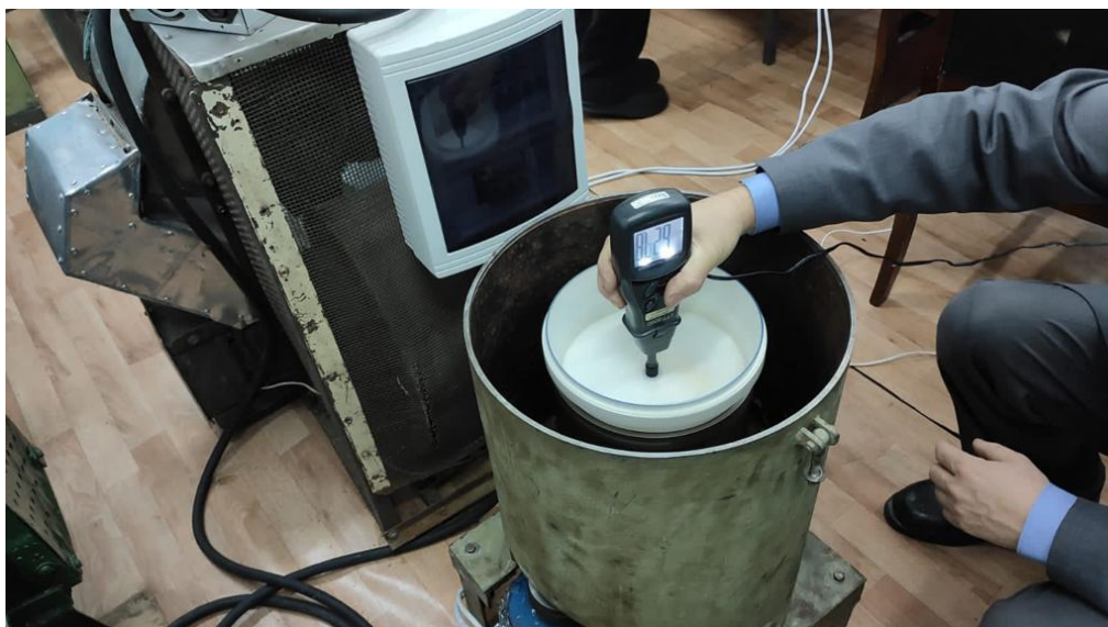
Рисунок И.7 - Ход эксперимента, снятие показаний цифровым тахометром: частота n=621,8 \text{ мин}^{-1}
