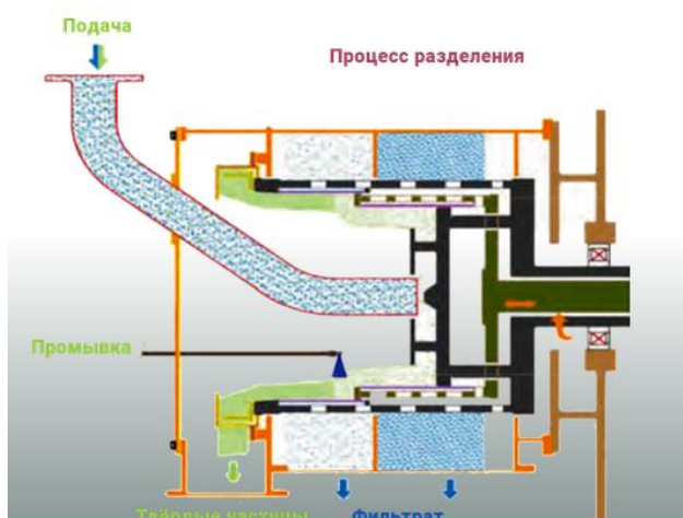
Рисунок 1.11 - Схема технологического процесса в центрифуге LLW
