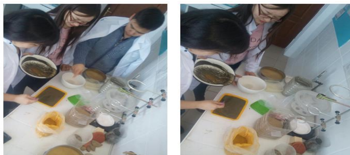
Сурет 1. Жасанды мәрмәнді зертханада дайындау процесі
