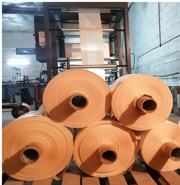
Рисунок 6 – Закатывание пленок в рулоны и их упаковка
