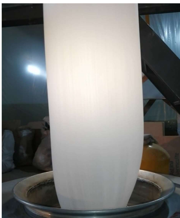
Рисунок 4 – Выдувание пленки в пленочном экструдере
