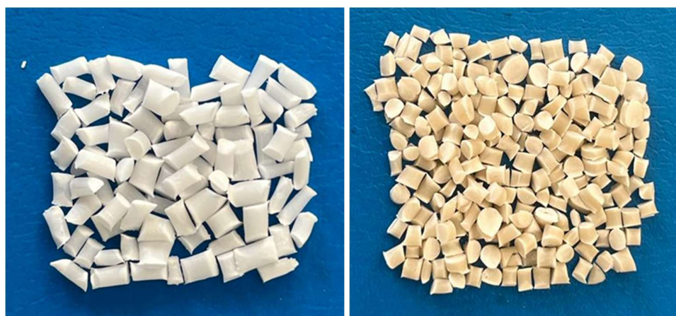
Рисунок 8 – Гранулы полученные из ацелированного А (слева) и В крахмала (справа)
