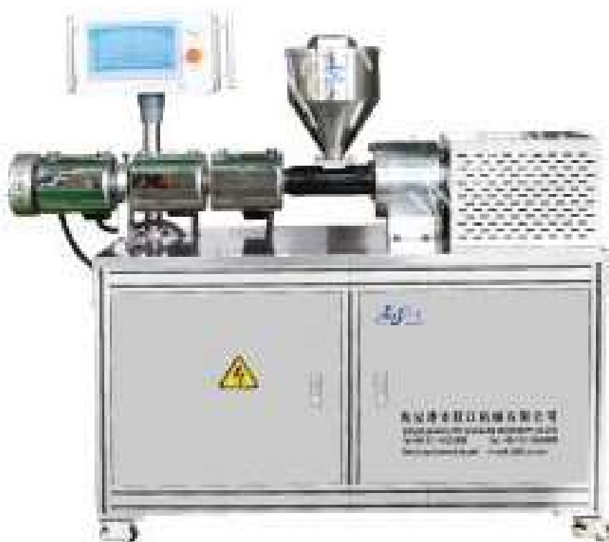
Рисунок 11 – Экструдер гранулятор (Single screw extruder)
