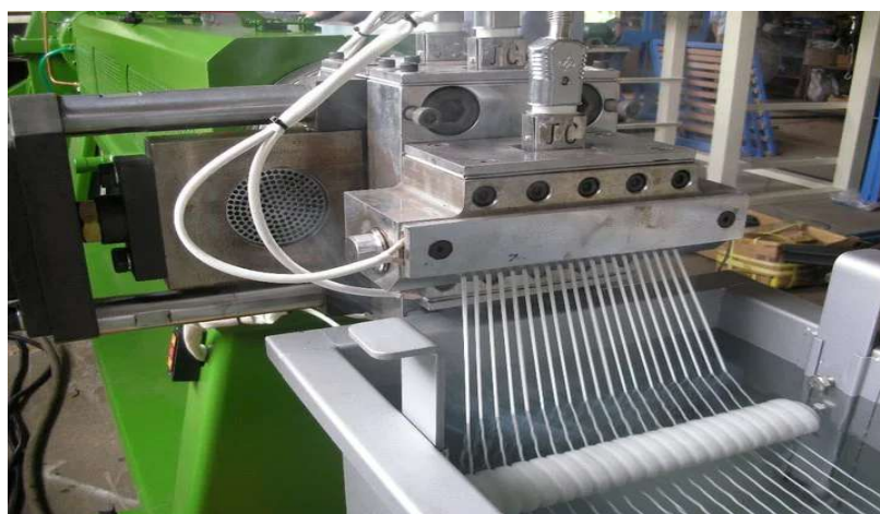
Рисунок 10 – Охлаждающая ванна для стренгов
