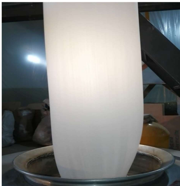
Рисунок 4 – Выдувание пленки в пленочном экструдере
