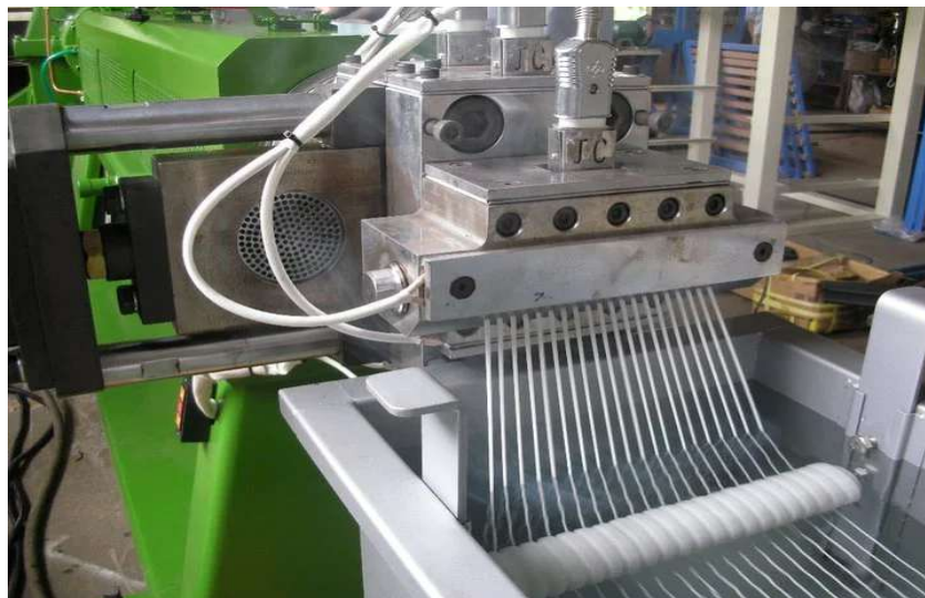
Рисунок 10 – Охлаждающая ванна для стренгов
