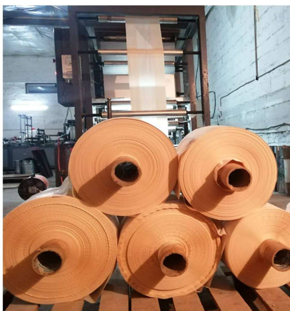
Рисунок 6 – Закатывание пленок в рулоны и их упаковка
