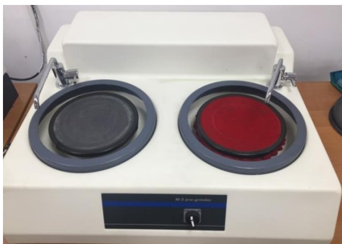
Сурет 3.10 – Металлографиялық үлгілерді алдын ала ажарлауға арналған станок
