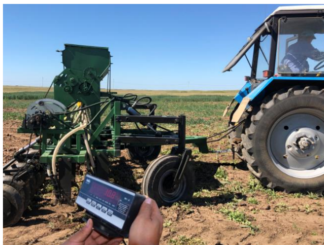
Сурет 4.7 – Эксперименттік астық-шөп-тыңайтқыш сепкішінің жалпы тарту кедергісін анықтау
