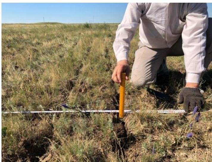
Сурет 4.11 – Шымдағы тұқымның тереңдігін анықтау
