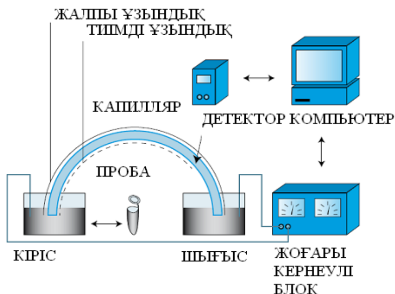
Сурет 2.10 - «Капель-105М» капиллярлық электрофорез жүйесі құрылымы
