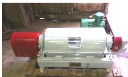
Рисунок 1.8 - Центрифуга серии ОГШ - ОГШ-202К-03
