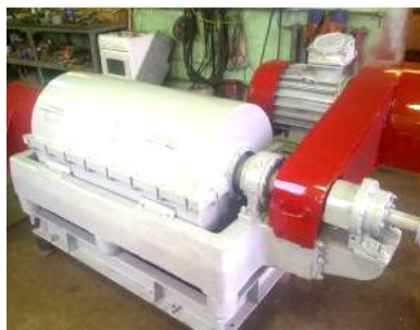
Рисунок 1.9 - Центрифуга серии ОГШ - ОГШ-352К-03
