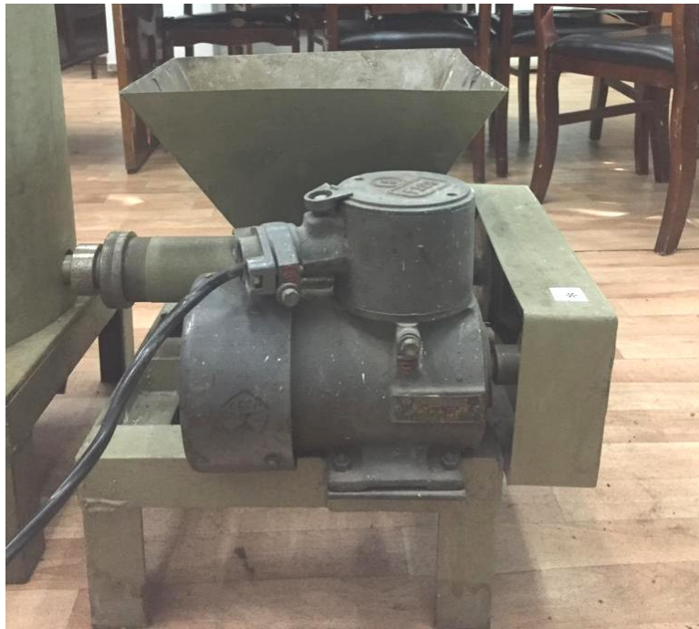
Рисунок И.3 - Привод с питателем для центрифуги
