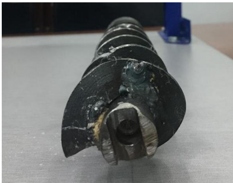
Рисунок И.5 - Шнек горизонтальный для подачи сырья
