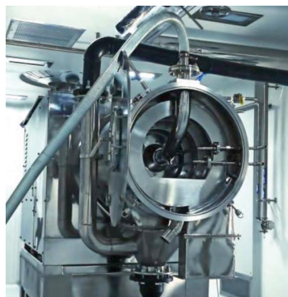
Рисунок 1.14 - Внешний вид типичной центрифуги серии LLW
