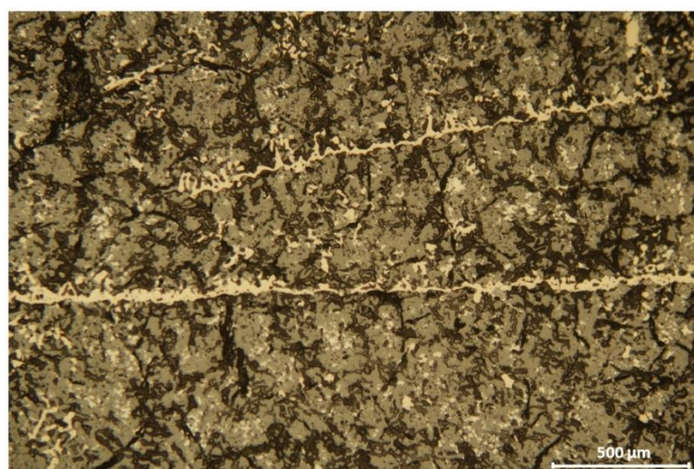
Рисунок 46 – Микроструктура кориума в области 4
