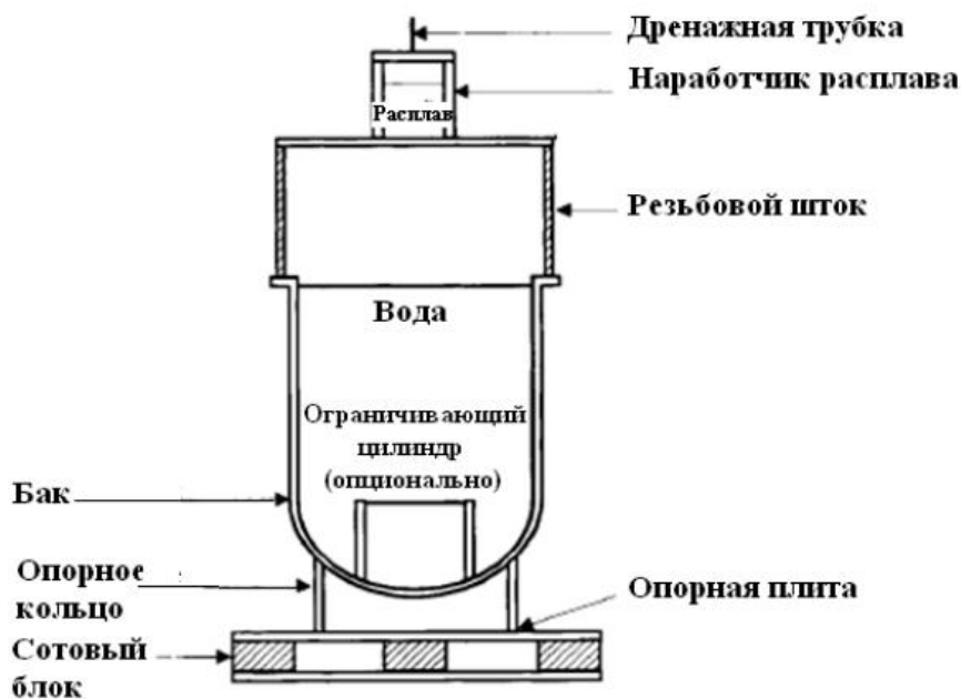
Рисунок 6 – Экспериментальная установка для проведения исследований паровых взрывов в открытой геометрии [47]
