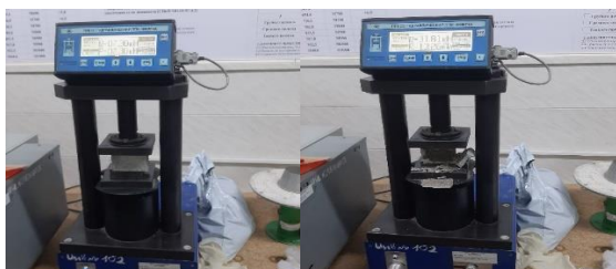
Рисунок 5 – Исследование образцов на сжатие
