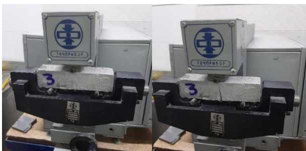
Рисунок 4 – Определение прочности на изгиб
