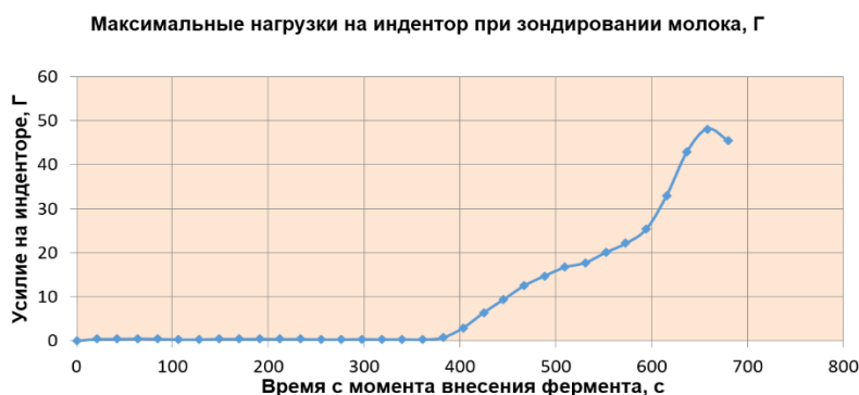
Рисунок 5 – Динамика изменения максимальной нагрузки на индентор в процессе свертывания молока без добавления экстракта хмеля
