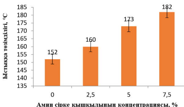
Сурет 11 – Құрамында 0,05 масс.б. АІN бар эпоксидті композиттің ыстыққа төзімділігінің амин сірке қышқылының концентрациясына тәуелділігі
