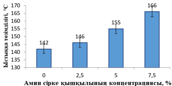
Сурет 9 – Құрамында 0,1 масс.б. наноалмаздар бар эпоксидті композиттің ыстыққа төзімділігінің амин сірке қышқылының концентрациясына тәуелділігі
