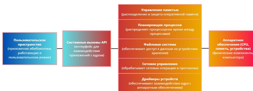
Рисунок 2 – Архитектура ядра операционной системы Linux и ее компоненты защиты
