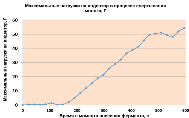
Рисунок 3 – Динамика изменения максимальной нагрузки на индентор в процессе свертывания молока без добавления экстракта хмеля
