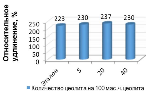
Рисунок 5 – Диаграмма зависимости относительного удлинения от содержания цеолита
