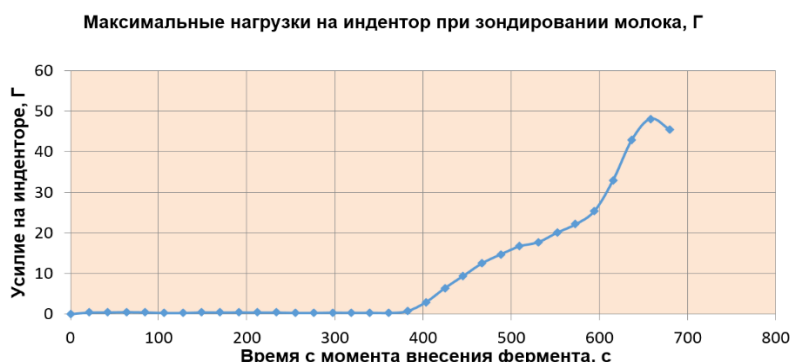
Рисунок 5 – Динамика изменения максимальной нагрузки на индентор в процессе свертывания молока без добавления экстракта хмеля
