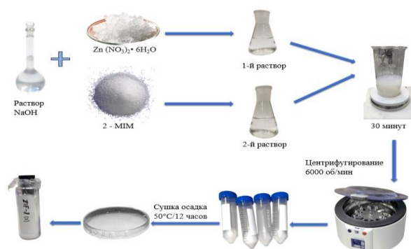
Рисунок 1 – Схема синтеза ZIF-8 при комнатной температуре
