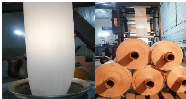
Рисунок 2 – Выдувание пленки в пленочном экструдере
