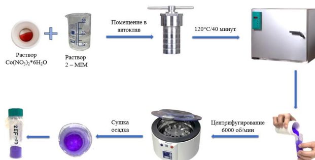
Рисунок 2 – Схема гидротермального синтеза ZIF-67
