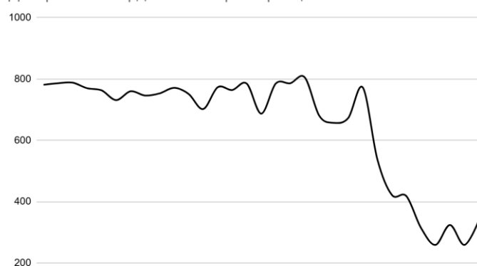
Диаграмма твердости шлифа образца стали 20ГЛ №4
